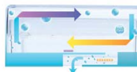
Levegőáramlási ciklus a hagyományos hűtőknél – veszik a nedvesség és az élelmiszerek kiszáradnak
